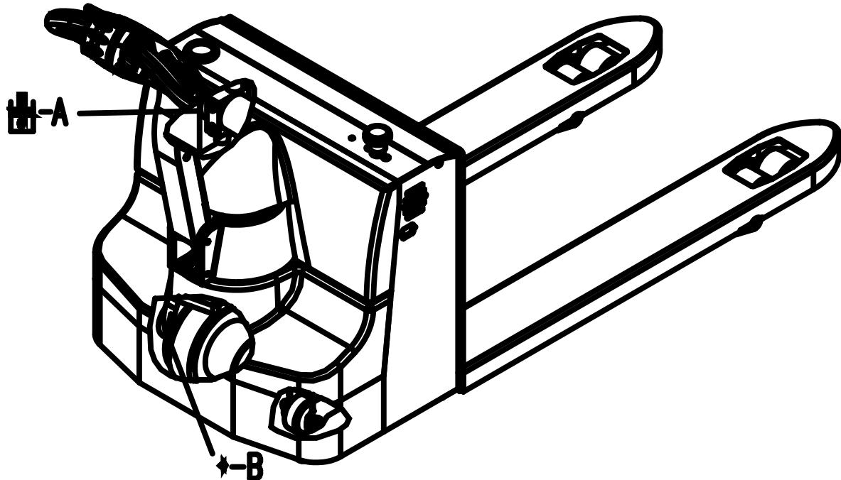
А - Отверстие для заливки гидравлического масла
